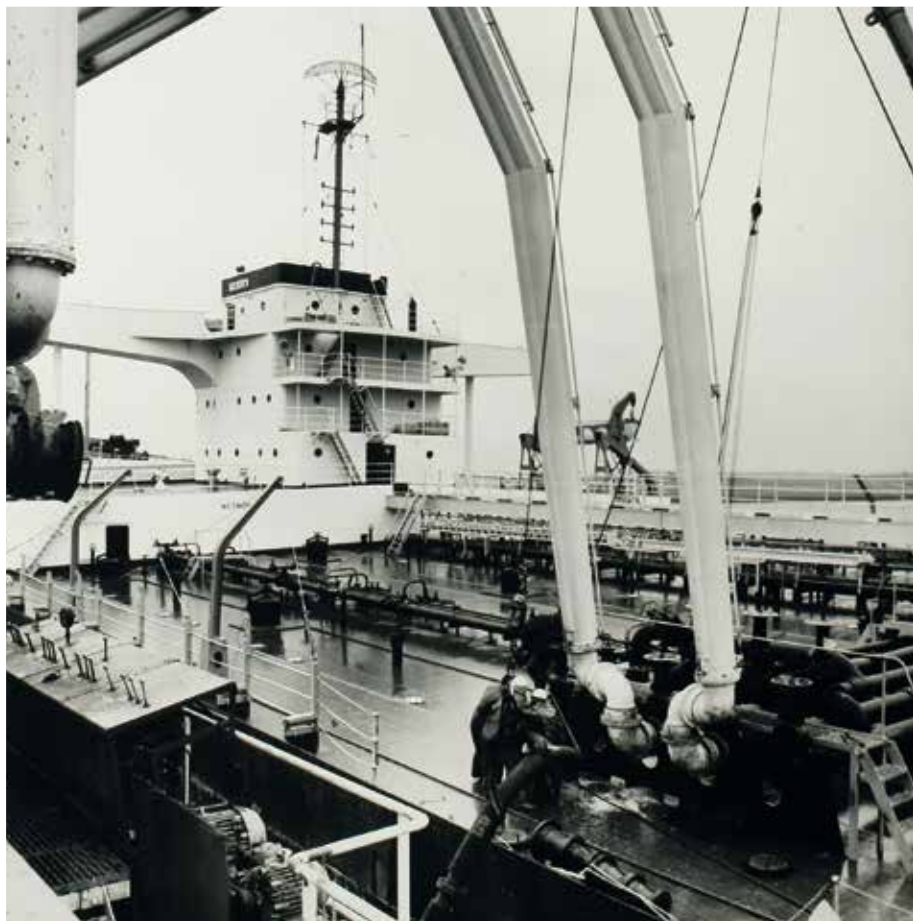
Overpompen van olieproducten, links is de arm van een jetty zichtbaar
